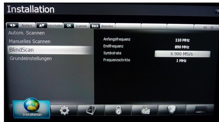
Von modernen digitalen Headends wird fast ausschließlich eine Symbolrate von 6900 MS/s verwendet.
